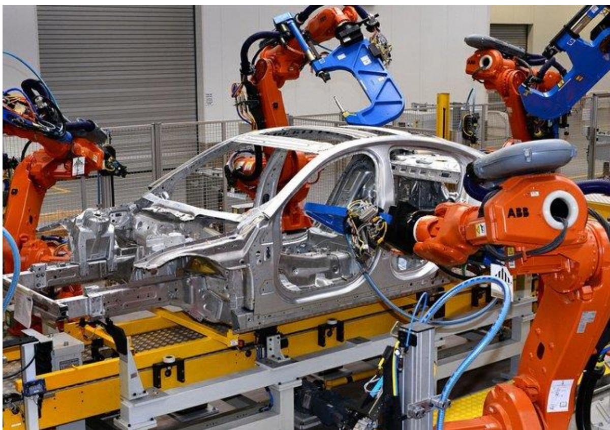
Slika 6.3. Rad robota na karoseriji automobila
