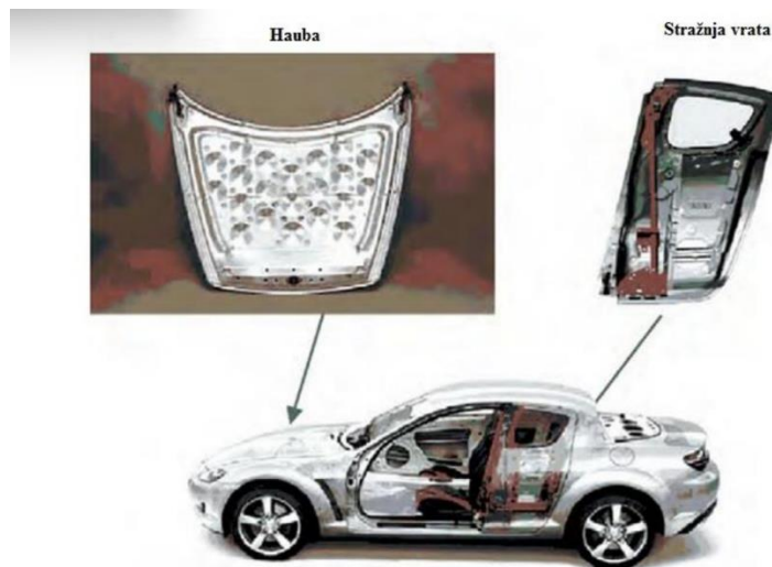
Slika 6.2. Zavarivanje dijelova trenjem na modelu automobila Mazda RX-8
