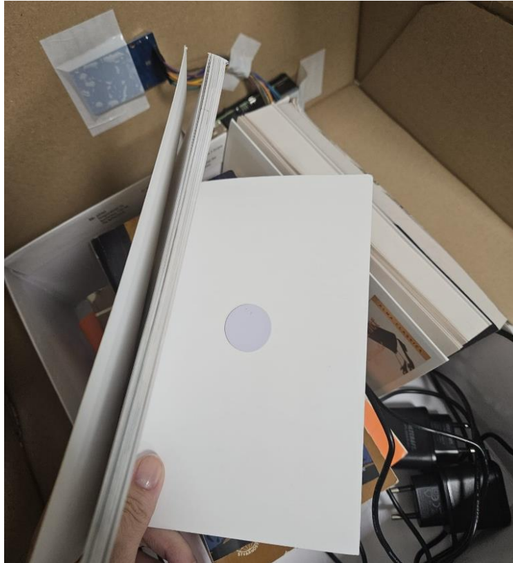
Slika 4.3 Prikaz RFID ljepljive oznake za knjige
